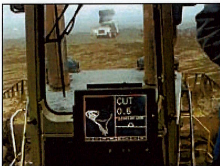
Figura 21 - Visão do operador de trator de esteiras com monitores. ( www.3dx.co.au )
