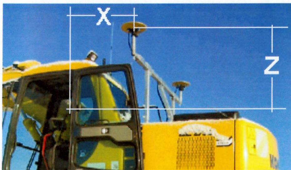
Figura 20 - Diferença de posição entre os receptores GPS e a cabeça do operador. ( http://www.topconeurope.com/ )
