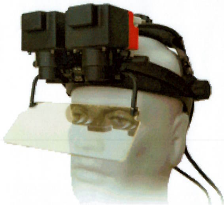
Figura 9 - Exemplo de vídeo-capacete de visão direta. ( http://www.vrealities.com/p-50.html )
