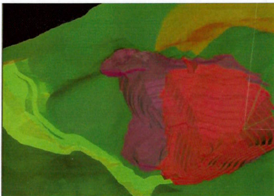
Figura 15 – Objetos tridimensionais (wireframes) representando topografia e cava a céu-aberto.
