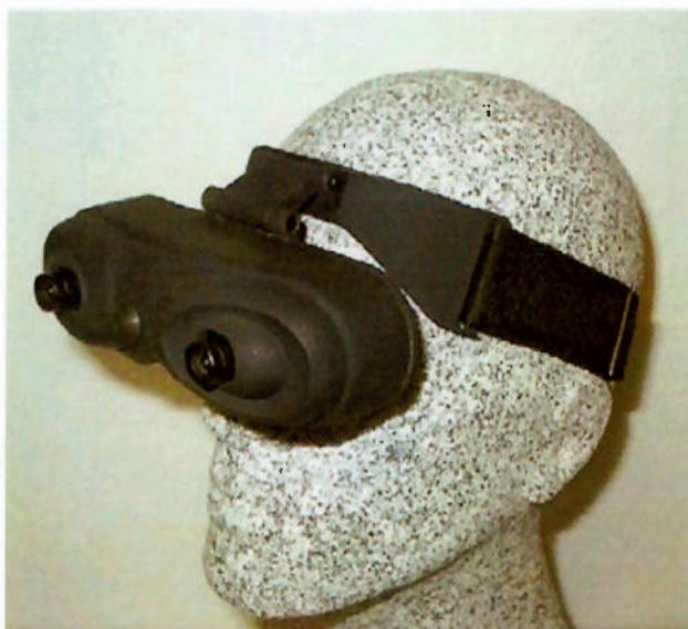
Figura 10 – Vídeo-capacete de imersão com câmera. ( http://www.vrealities.com/arvision-3d.html )
