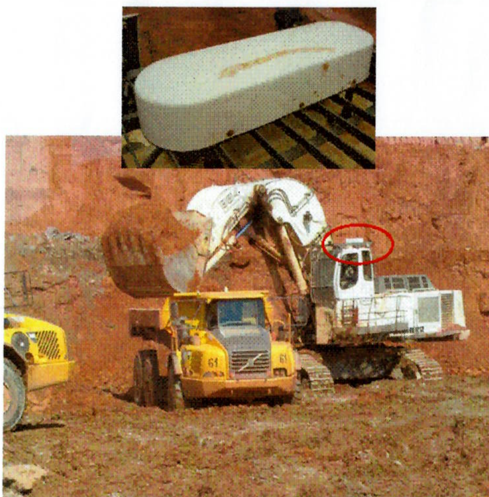
Figura 5 – Detalhe do GPS de alta precisão instalado em escavadora. (Cedida pela empresa Devex)
