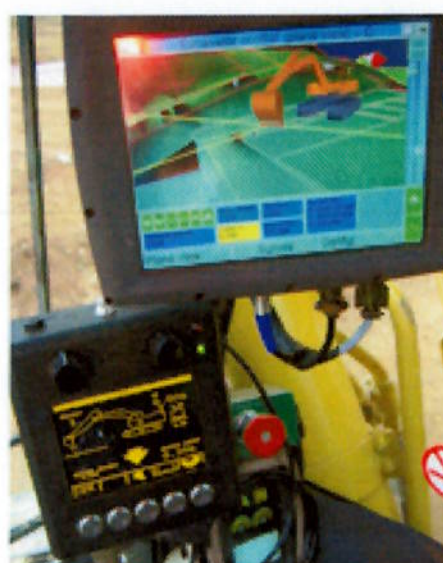
Figura 22 - Visão do operador de retroescavadora com monitores. Sistema atualmente no mercado ( www.3dx.co.au ).
