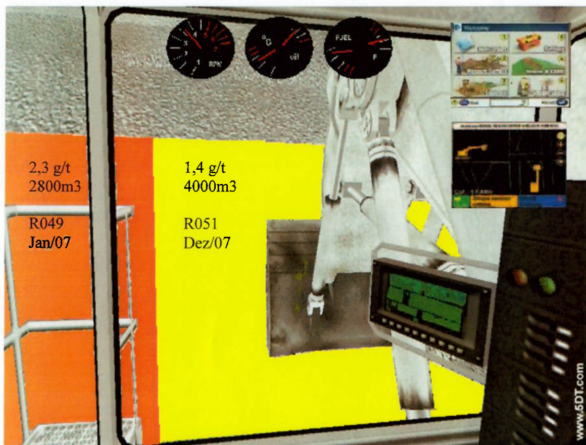
Figura 23 – Montagem da visão do vídeo-capacete de visão direta utilizado pelo operador da escavadora, proposta neste trabalho. Nos detalhes, as informações vindas de fontes externas, como sensores de posição do braço da escavadora e painel virtual do motor. Em amarelo e laranja, os blocos de curto-prazo a serem lavrados, com anotações pertinentes ao operador. (Cortesia de imagem original: www.5DT.com )
